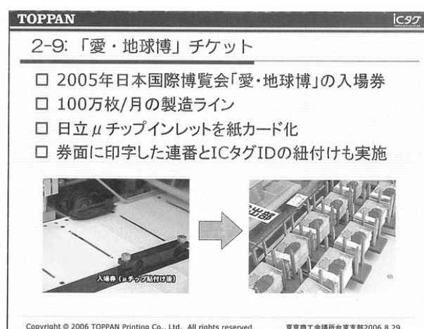
図 6-9. 愛・地球博での紙チケットへの IC タグ内蔵事例(凸版資料より)
