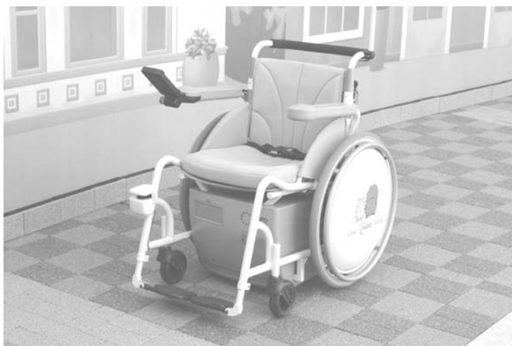
図 3-18. 愛・地球博で実証実験されたインテリジェント車椅子 TA0 Aicle GPS、方位センサー、路面に埋め込まれた IC タグにより目的地まで自動走行 右肘に操作&ガイド表示端末が装着されている
