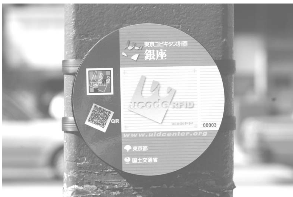
図 3-13. 無線 IC タグ、ucode 認定の 3 種コードが内蔵されたパネル
